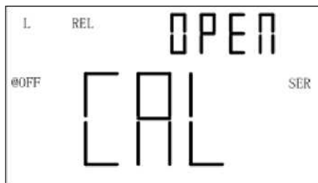
Рисунок 9 Калибровка в состоянии холостого хода (XX)
