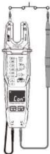
Проверка цепи на обрыв
