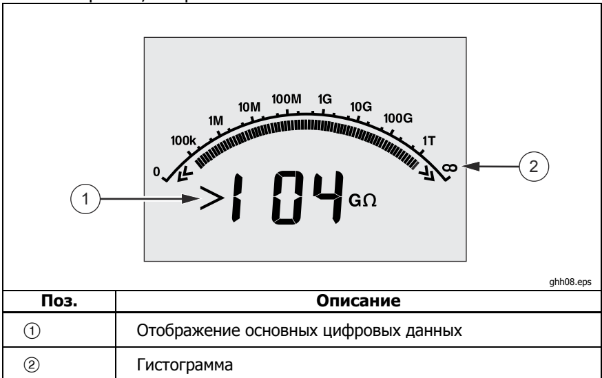
Рисунок 11. Отображение измеренного сопротивления изоляции
