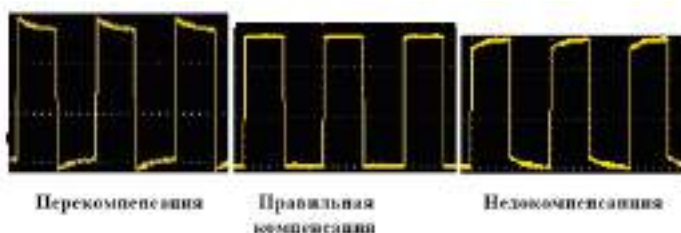
Рисунок 4-7 Варианты осциллограммы при компенсации пробника
