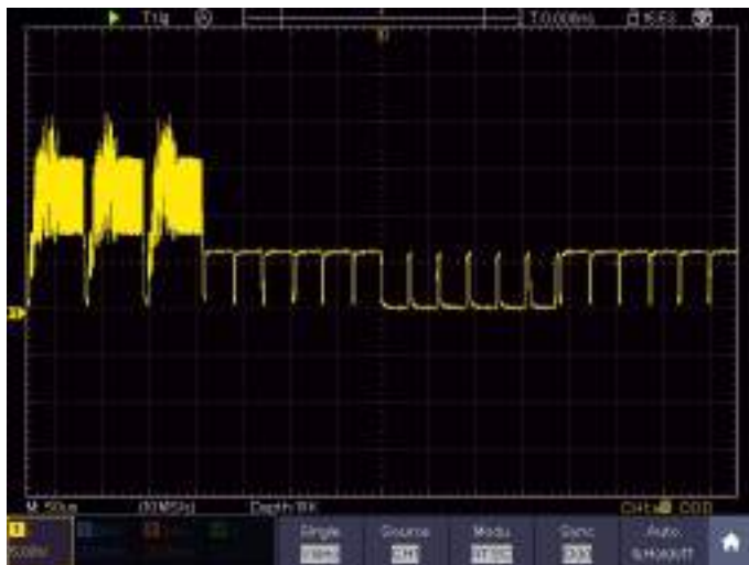
Рисунок 9-7 Осциллограмма, полученная с помощью триггера по видеополю
