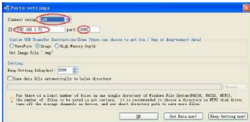
Рисунок 8-6 Установка сетевых параметров осциллографа
