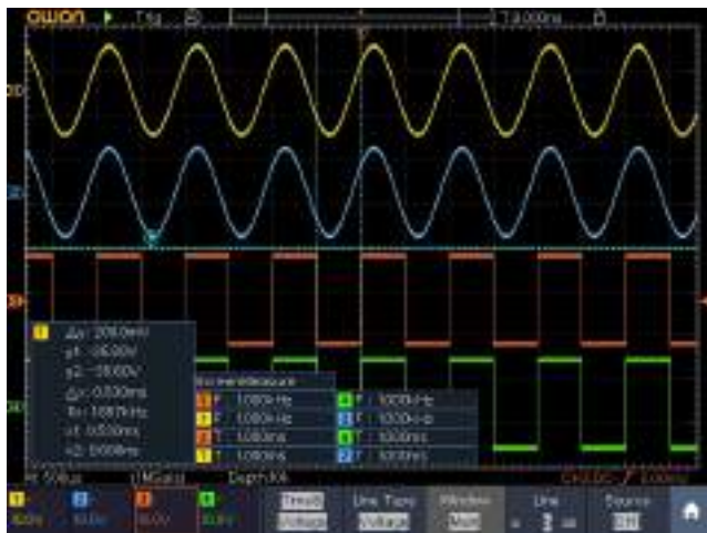
Рисунок 5-26 Курсорные измерения времени и напряжения
