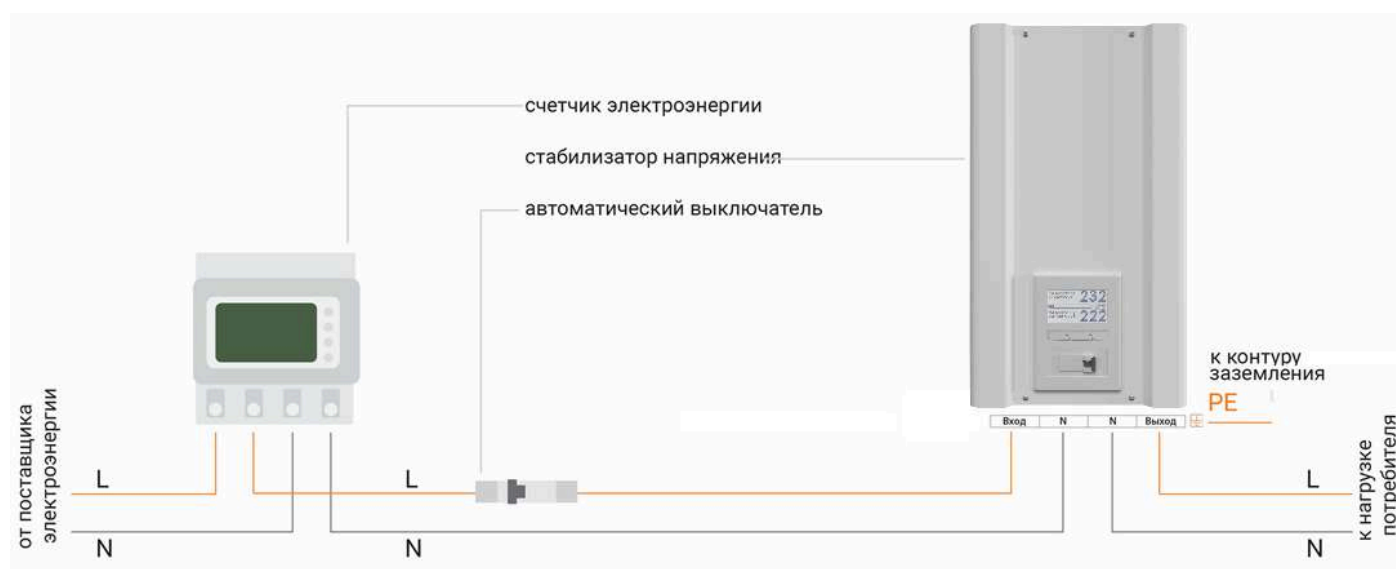
Рисунок 6. Схема подключения стабилизатора к однофазной сети
