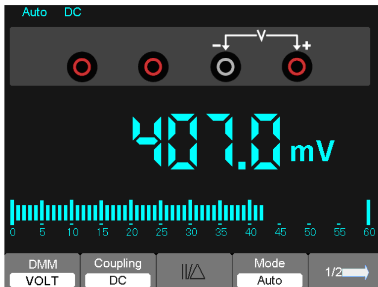
Рисунок 7-6 Измерение напряжения постоянного тока
