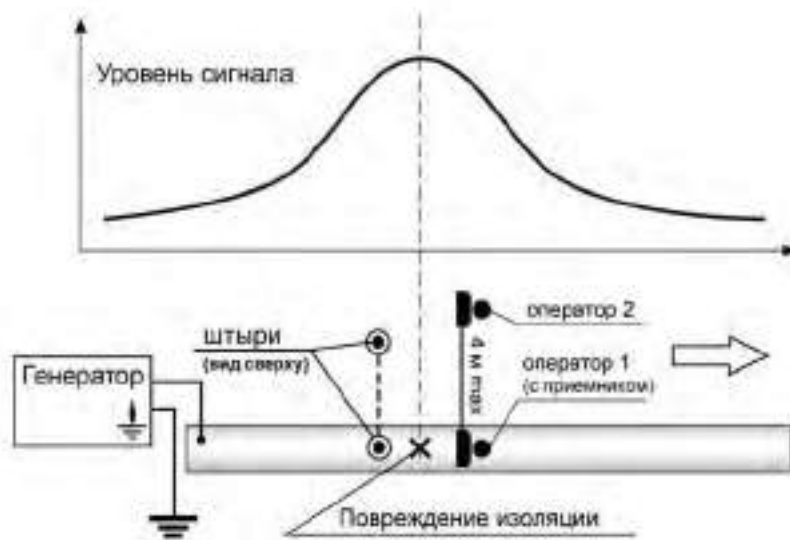
Рисунок 5.2.2 – Схема подключения и уровень сигнала при поиске повреждения изоляции по «максимуму»
