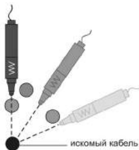
Рисунок 5.4.2 – Поиск кабеля (жилы) по минимуму сигнала
