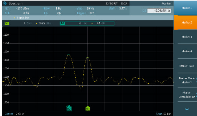
Опция R&S®FPC-B22: высокая чувствительность с внутренним предусилителем
