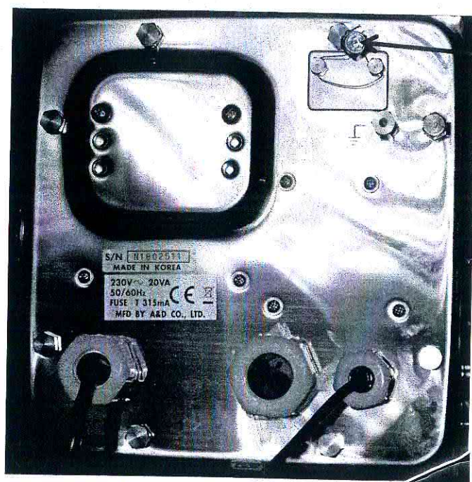
Рисунок 2 - Место пломбировки весов
