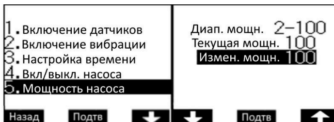
Рис. 6. Настройка мощности прокачки насоса
